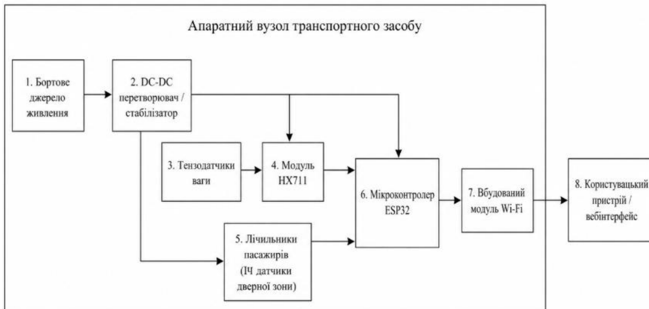
Рисунок 3.1 – Структура апаратного вузла системи моніторингу заповненості громадського транспорту
