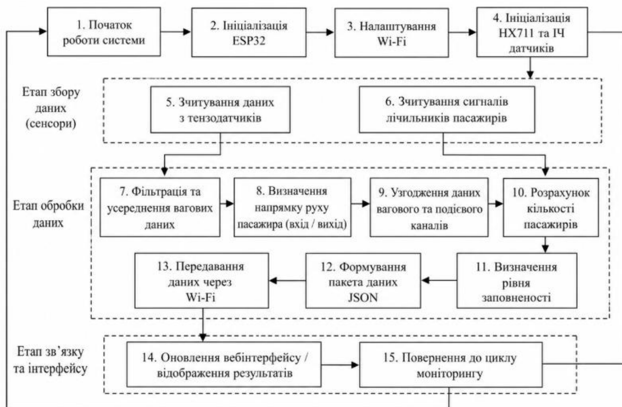
Рисунок 3.2 – Структура програмної логіки мікроконтролера ESP32
