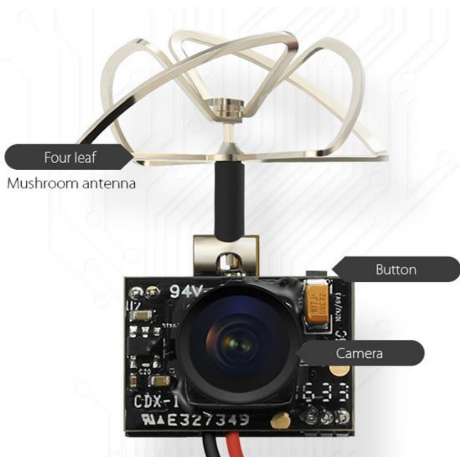
Рисунок 3.1 – Зовнішній вигляд камери Eachine TX02
