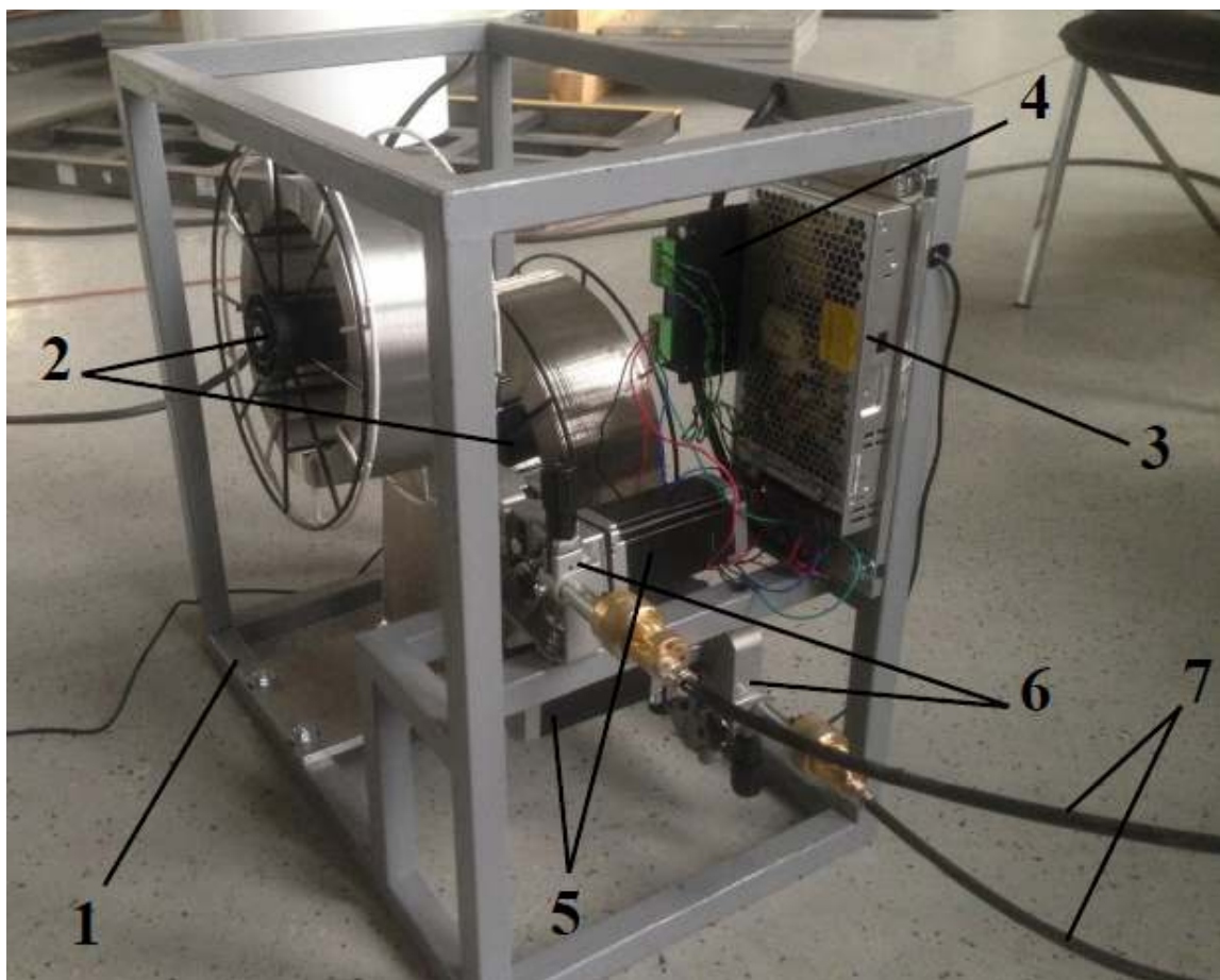
Рисунок 2.1 – Дослідна конструкція для здійснення одночасної механізованої подачі двох різнорідних зварювальних дротів: 1 - корпус конструкції; 2 - місце встановлення касети з дротом; 3 – джерело живлення; 4 - програмований мікроконтролер; 5 – кроковий електродвигун; 6 - механізм подачі дроту типу, що штовхає; 7 - кабель канал
