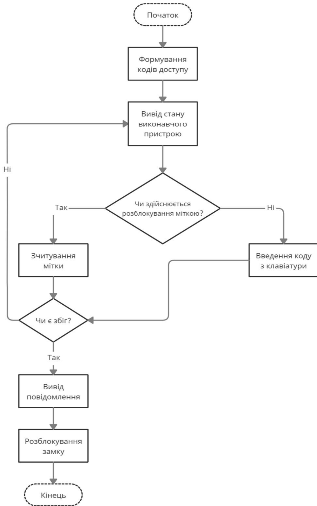
Рисунок 3.8 — Блок-схема алгоритму функціонування системи автоматизованої системи контролю доступу
