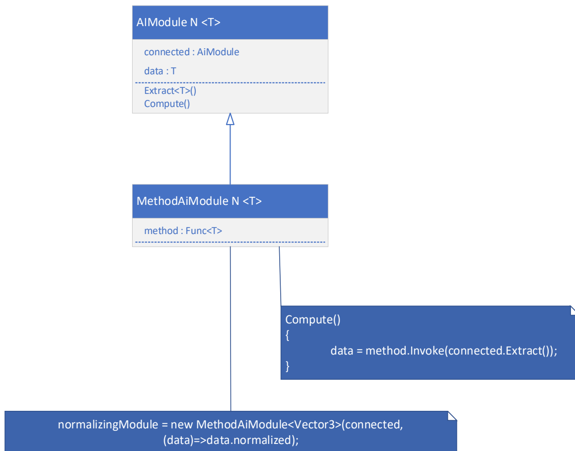
Рисунок 3.6 – Приклад реалізації модуля нормалізації вектора способом використання зовнішньої функції
