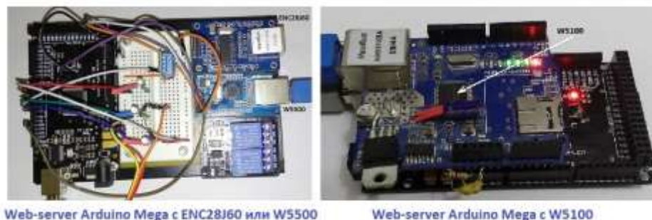
Рисунок 2 – Web-сервера Arduino Mega с сетевыми контроллерами ENC28J60, W5100, W5500
