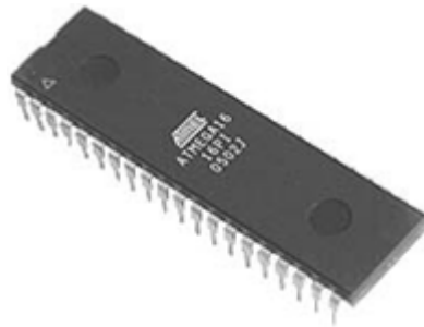
Рисунок 3.13- Мікроконтролер АТmega 16 компанії АТmel .
