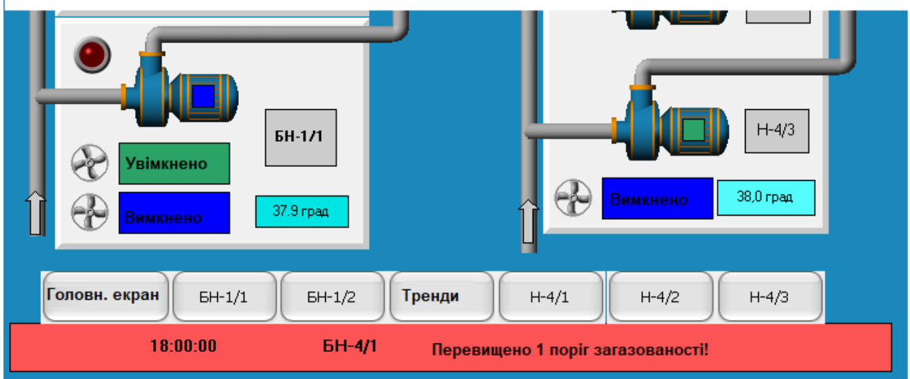
Рисунок 2.8 – Загальний вигляд НМІ при перевищенні ступеня загазованості приміщення
