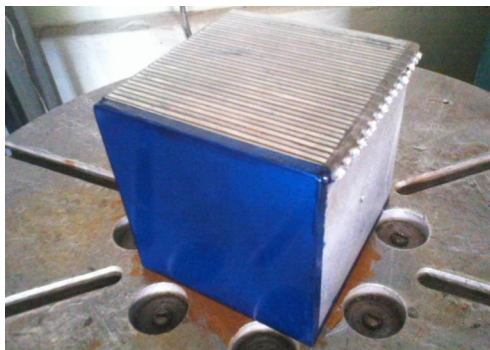
Рис. 3. Електростатичний кріпильний пристрій з нанесеною паяльною маскою
