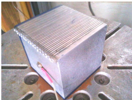
Рис. 1. Модель електростатичного кріпильного пристрою у формі куба
