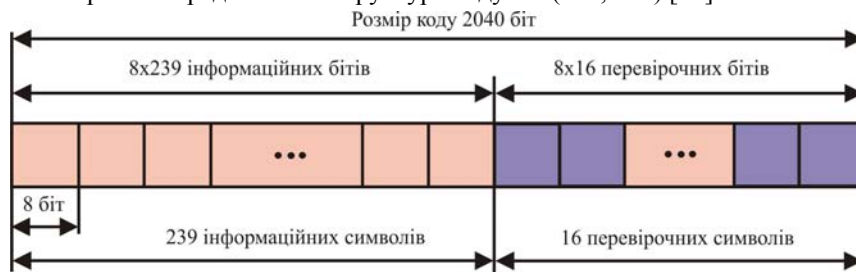
Рис. 11. Структура коду Ріда-Соломона (255, 239)
