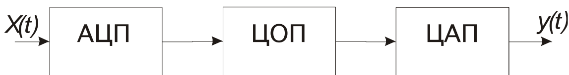
Рисунок 1.1 – Блок-схема здійснення цифрових перетворень аналогового прийнятого сигналу: АЦП – аналогово-цифровий перетворювач; ЦОП – цифровий обчислювальний пристрій; ЦАП – цифрово-аналоговий перетворювач
