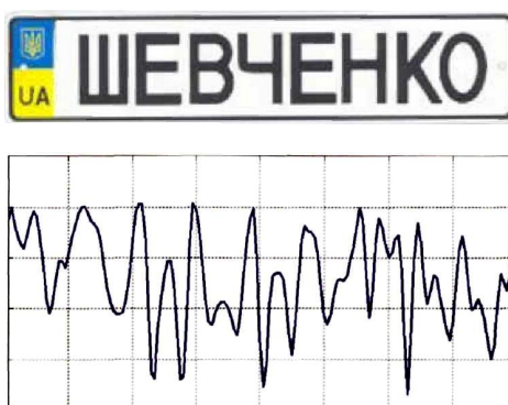
Рисунок 2.2 – Сегментація номерного знаку методом проєкцій
