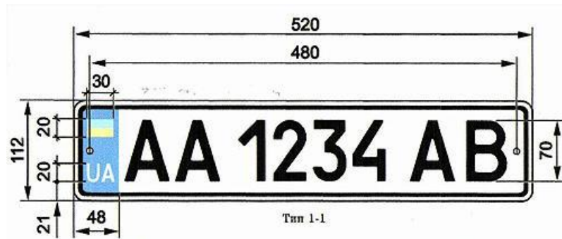
Рисунок 1.5 – Детальні розміри номерного знаку для всіх типів автомобілів
