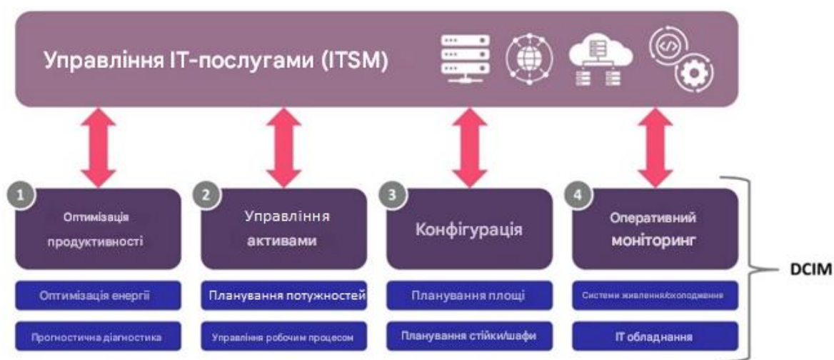
Рисунок 1.18 – Загальна схема роботи DCIM–платформи [38]
