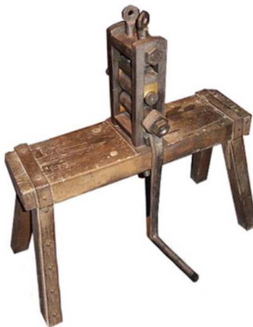
Рисунок 1.2 – Вальцювальний верстат у ТП КМ, що застосовувався для виготовлення (розробки) необхідної товщини М
