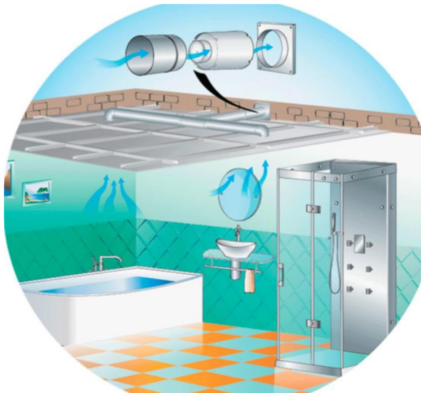
Рисунок 2.19 – Спосіб роботи каналного вентилятора та місце розташування
