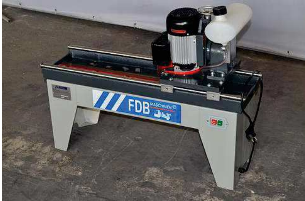
Рисунок 1.3 - Вигляд серійного заточувального верстату FDB Maschinen TS 700
