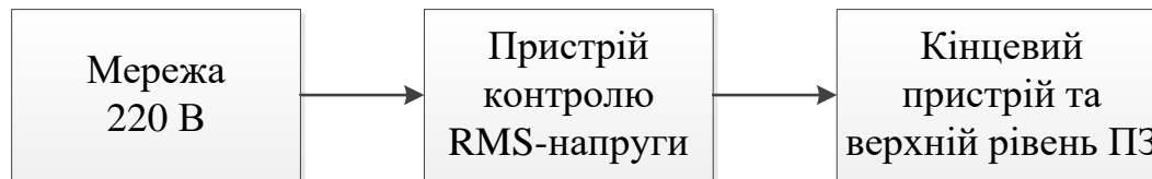
Рисунок 2.1 – Структура системи моніторингу діючого значення напруги мережі 220 В
