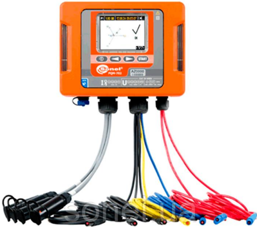
Рисунок 1.2 – Зовнішній вигляд аналізатора якості електроенергії Sonel PQM-710UA
