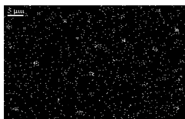
Рис. 12 – Мікроструктура доріжок тертя сталі ХВГ з покриттям \text{Al}_2\text{O}_3\text{-Ni} (а, б) і розподіл елементів: в – Al, г – Ni (x 2500); а – зображення від вторинних електронів; б – зображення від відбитих електронів
