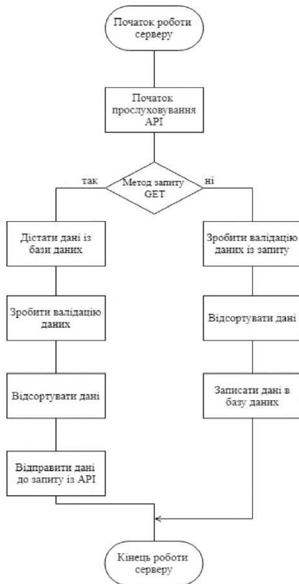
Рисунок 4.8 – Блок-схема алгоритму роботи серверної частини
