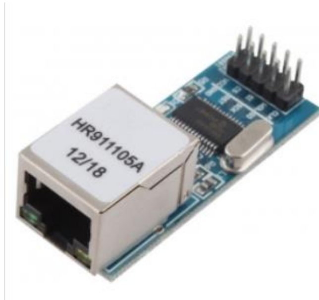
Рисунок 2.10 - ENC28J60 Ethernet модуль міні
