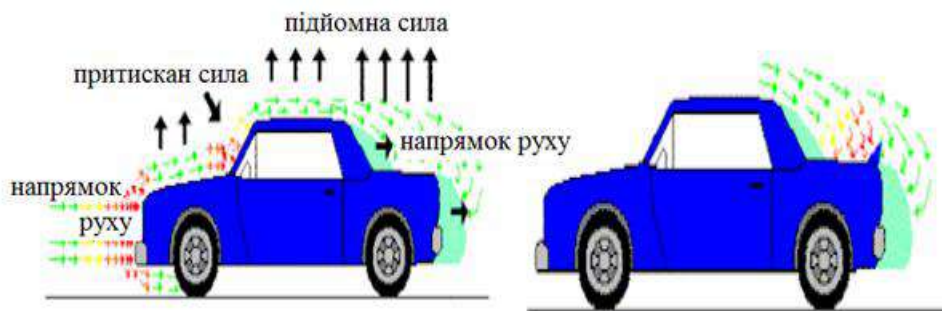
Рисунок 1.1 – Траєкторія обтікання повітря без та з спойлером.
