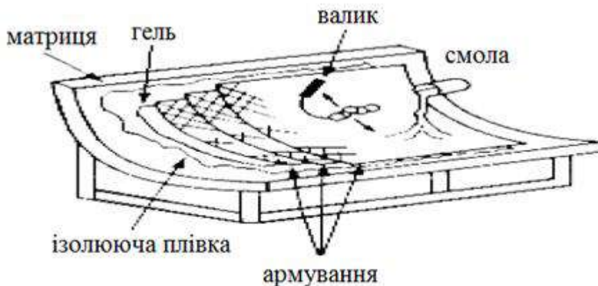
Рисунок 2.1 – Процес ручного укладання.
