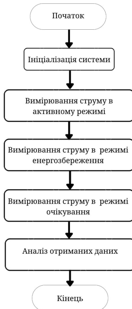
Рисунок 4.8 - Блок-схема алгоритму вимірювання енергоспоживання мікроконтролера
